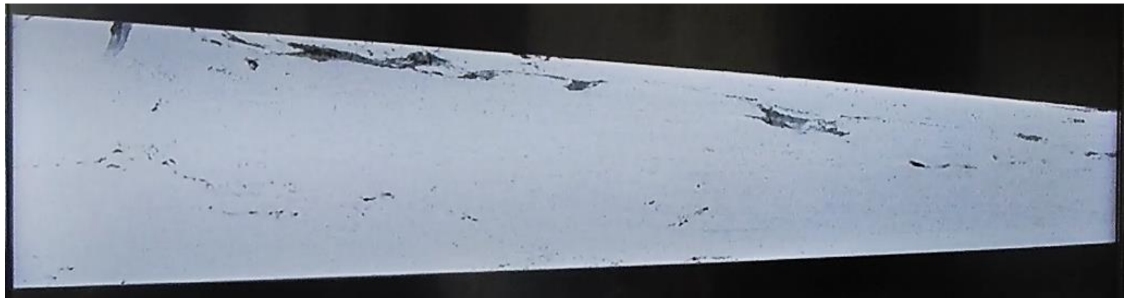
大宮蔵鼓神社 蔵手刀の放射光(佐用 スプリング8)照射による断面解析画像
