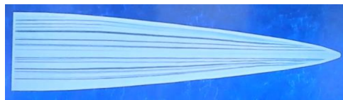
大宮蔵鼓神社 蔵手刀の放射光(佐用 スプリング8)照射による断面解析画像
