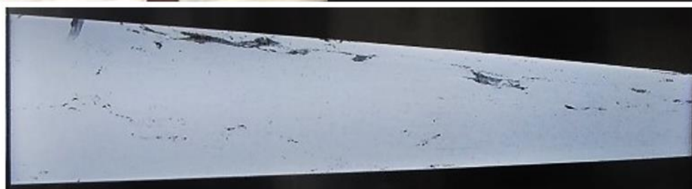
大宮蔵鼓神社 蕨手刀の放射光(佐用 スプリング8)照射による断面解析画像
