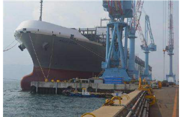
今治造船広島工場で建造されている約1万4000個積みの大型コンテナ船。来年にはさらに大きい2万個積みが建造できる超巨大ドックを新設する
