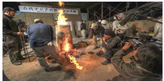
古墳時代の製鉄炉の復元 (アジア産業考古学研究センターと 中国新疆吐鲁番地区伝承会とのコラボレーション)
