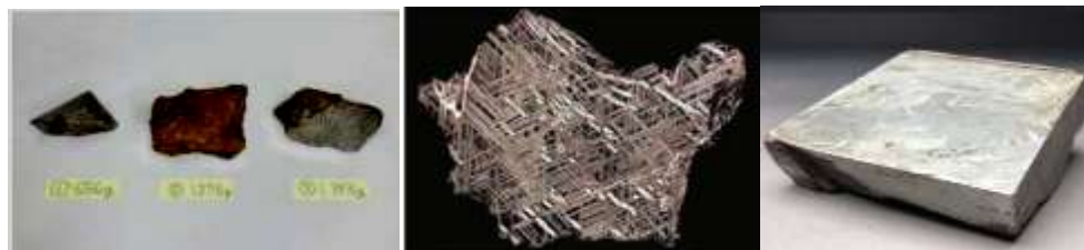
宇宙の贈り物 隕鉄素材と切断表面のウイドマンシュテッテン構造凝固模様
