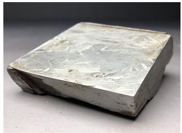
写真3 鍛造前の新疆アルタイ隕鉄(700g)。
