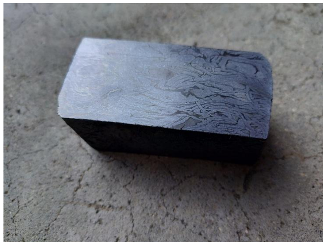
写真 4 鍛造後の隕鉄（500g）。
