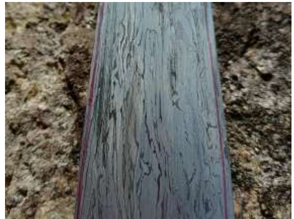
短剣表面に現れたウィドマンシュテッテン組織の加工変形模様
