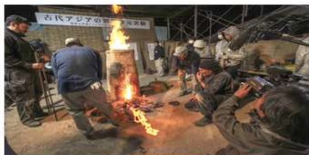
古墳時代の製鉄炉の復元（アジア産業考古学研究センターと中国新疆見庄たたら伝承会とのコラボレーション）
