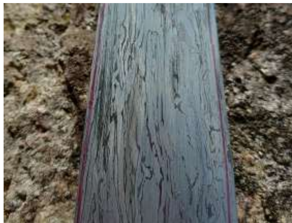
短剣表面に現れたウィドマンシュテッテン組織の加工変形模様
