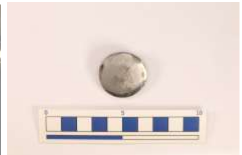
松山で鍛えて研磨した隕鉄製円盤
