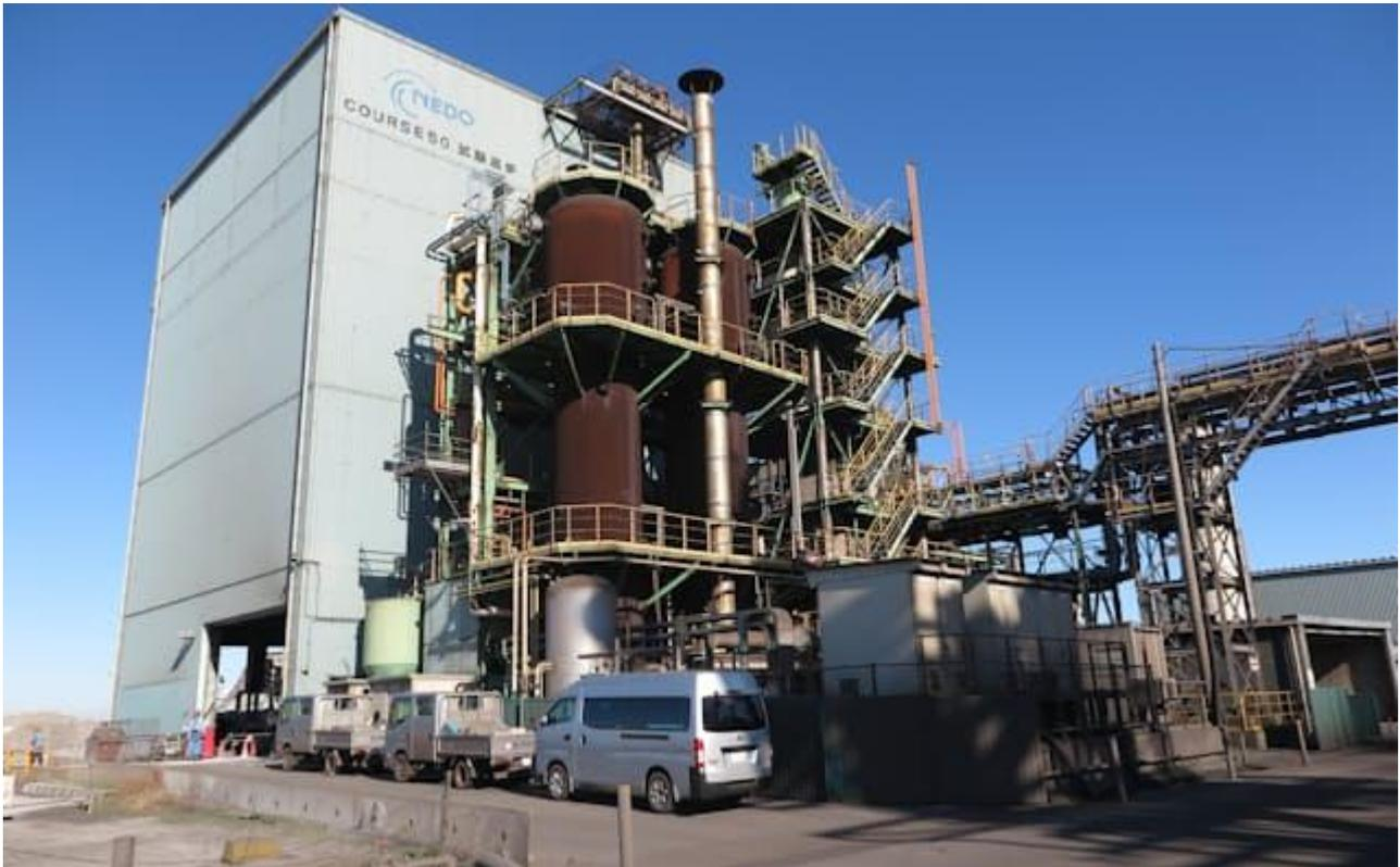
日本製鉄は千葉県君津市の製鉄所で高炉水素還元の実証試験に取り組んでいる
