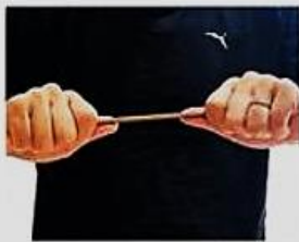
銅などでできた形状記憶合金を曲げた状態（上）。力を抜くと元の真っすぐな形に戻った
