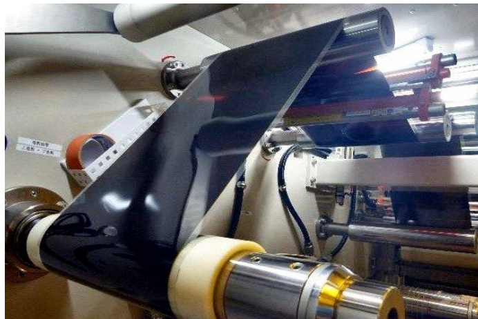
積水化学は 30 センチメートル幅のロール・ツー・ロール方式で PSC を生産する要素技術をほぼ確立した（積水化学提供）
