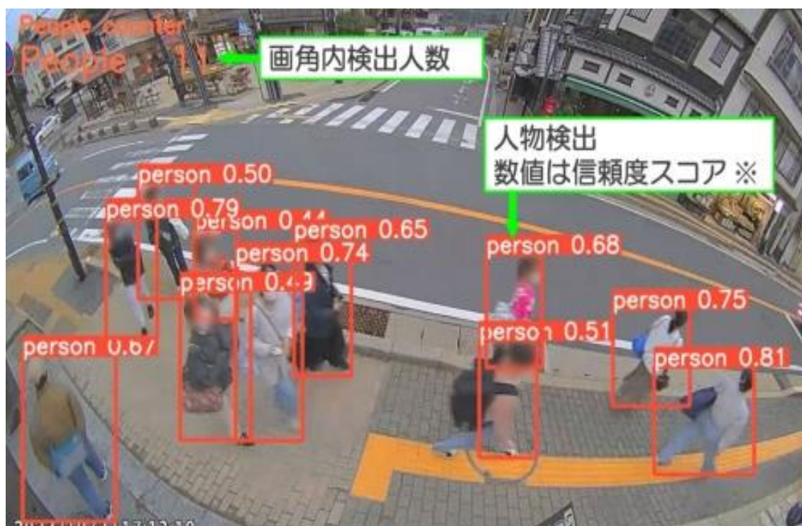
画像認識AIによる人流計測システム。ネットワークカメラの映像から各観光スポットの通行量を分析。観光客のスマートフォンの位置情報などと組み合わせて、回遊性向上や渋滞対策につなげる（出所：大成建設）
