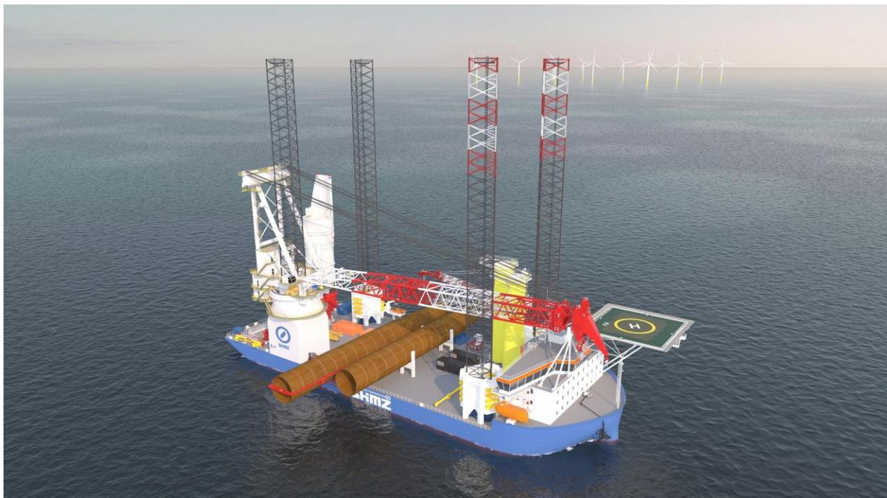
発電能力の規模や安定性から、再生可能エネルギーの中でも期待の高い洋上風力発電。風車の基礎部分を海底に固定する「着床式」と、海上に浮かべた構造物の上に風車を載せる「浮体式」の2種類があり、大型の着床式風車は、SEP 船と呼ばれる作業船を使って建設します。シミズはこのたび、12MW 級の大型風車にも対応できる世界最大級の自航式 SEP 船の建造に着手しました。
