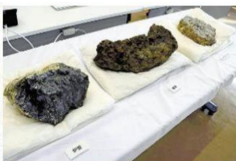
遺跡から見つかった製鉄炉の破片(左)や、製鉄の際に出る不純物(中央)など(松江市で)
