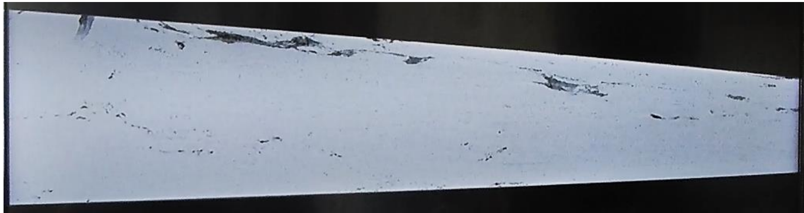
大宮巖鼓神社 蕨手刀の放射光(佐用 スプリング8)照射による断面解析画像
