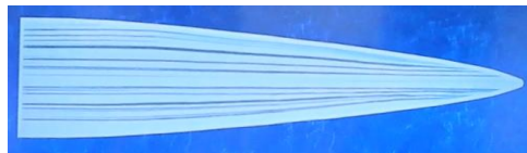
大宮巖鼓神社 蕨手刀の放射光(佐用 スプリング8)照射による断面解析画像
