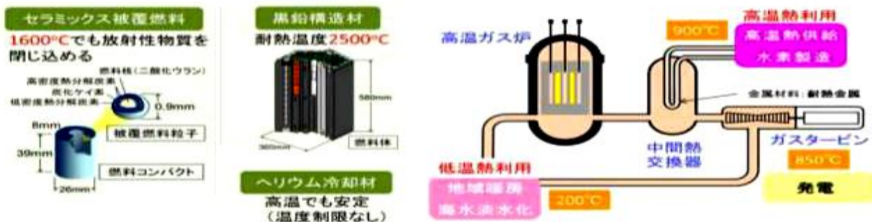
図1 高温ガス炉の特長
