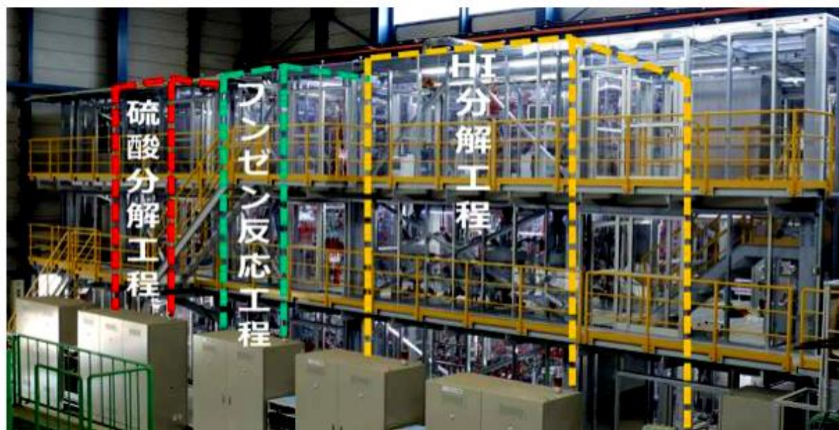
熱化学法 IS プロセスによる水素製造試験装置（3 反応工程で構成）
