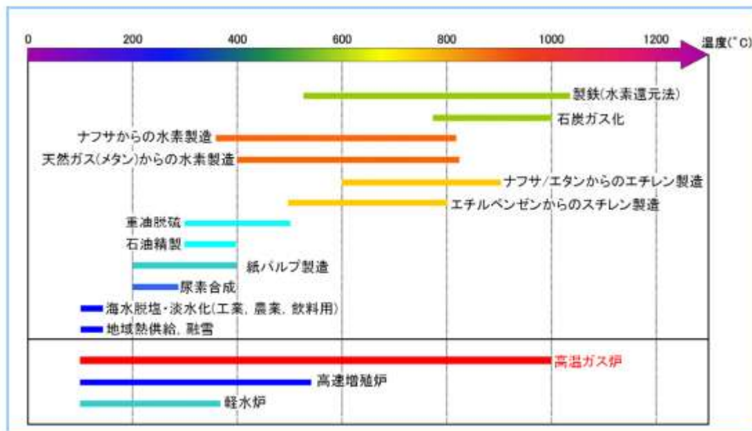
図2 高温ガス炉の供給可能温度範囲と一般産業における利用温度範囲 (3)
